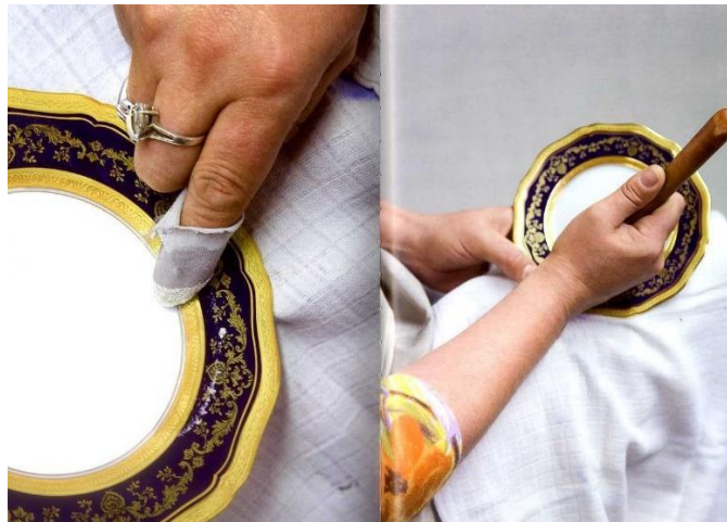
Technique d'incrustation : polissage à l'agate
