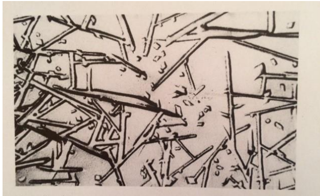
La mullite vue au microscope électronique : on distingue clairement les aiguilles de mullite bien formées
